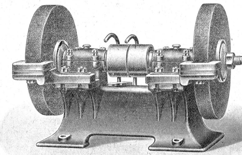
mit Ringschmier- oder Kugellagerung, in diversen Grössen,
