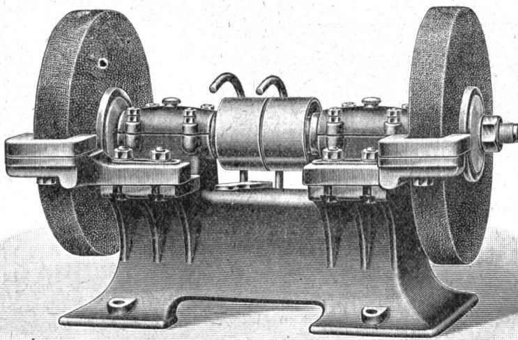
mit Ringschmier- oder Kugellagerung, in diversen Grössen,
