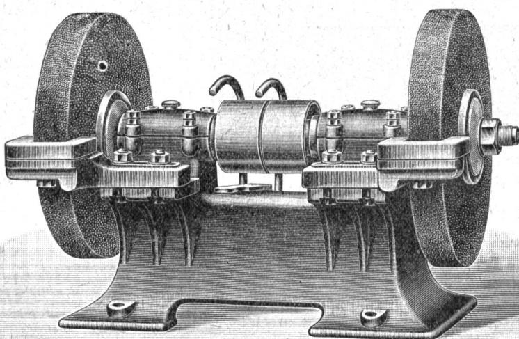
mit Ringschmier- oder Kugellagerung, in diversen Grössen,
