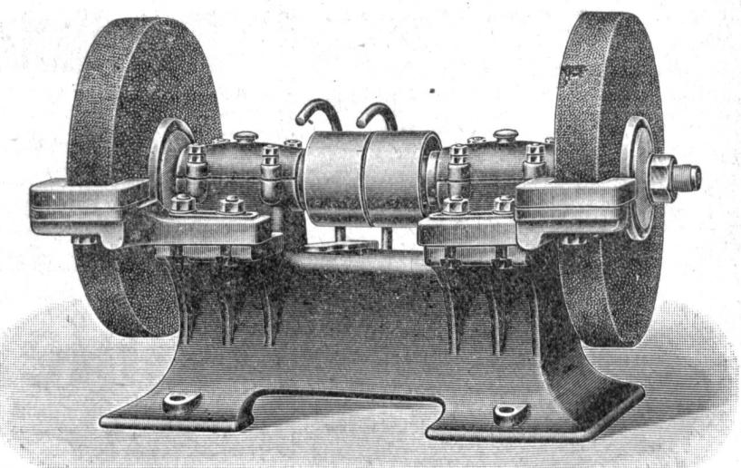
mit Ringschmier- oder Kugellagerung, in diversen Größen,
