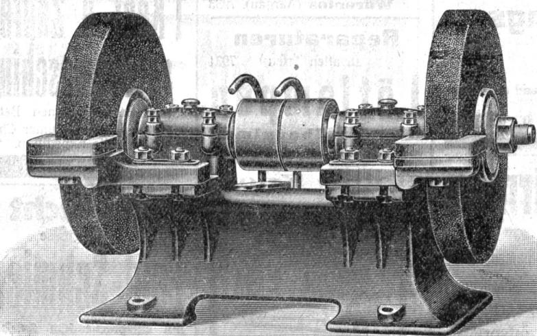
mit Ringschmier- oder Kugellagerung, in diversen Größen,
