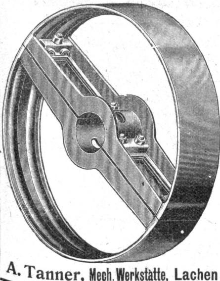
von 200 bis 1200 mm Durchmesser, mit auswechselbaren Büchsen auf jede Welle passend, 50 bis 70 % leichter als gusseiserne Scheiben, sofort lieferbar bei [3975]
