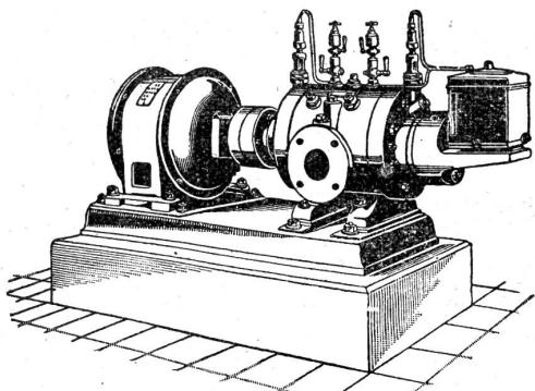
**Direkte Kupplung** mit Elektromotoren od. Riemenbetrieb.
