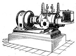
Direkte Kupplung mit Elektromotoren od. Riemenbetrieh
