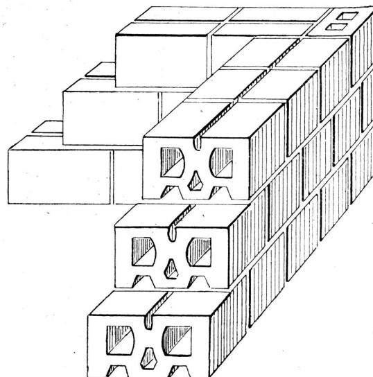
Mauerstärken von 12, 15, 25, 30, 38 usw. cm festzuhalten, weil Läufer und Binder von 12, 15, 25 und 30 cm hergestellt werden. Die Höhe der Steine von 13 cm entspricht der Höhe von zwei Normalsteinen mit einer Lagerfüge. Es ist demnach möglich, bei Erkervorbauten, Umbauten und Reparaturen Aristos mit gewöhnlichem Mauerwerk in richtigen Verband zu bringen.
