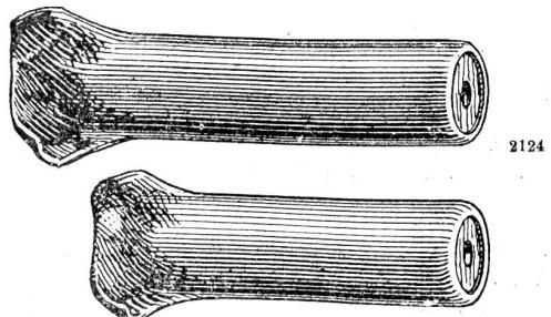
mit eingepresster, quer geschnittener Hartholzfüllung und vorn eingebogener Eisenhülse, in Längen von 30—80 mm und Dicken 9, 11, 14 mm, ist der solideste und zweckmässigste Dübel für alle Zwecke.
