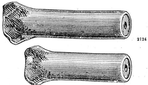
mit eingepresster, quer geschmittener Hartholzfüllung und vorn eingebogener Eisenhülse, in Längen von 30—80 mm und Dicken 9, 11, 14 mm, ist der solideste und zweckmässigste Dübel für alle Zwecke.
