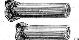
mit eingepresster, quer geschnittener hartholzfüllung und vorn eingebogener Eisenhülse, in Längen von 30—80 mm und Dicken 9, 11, 14 mm, ist der solideste und zweckmässigste Dübel für alle 3wecke.
