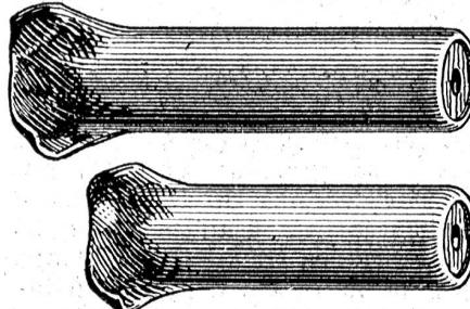
mit eingepresster, quer geschnittener Hartholzfüllung und vorn eingebogener Eisenhülse, in Längen von 30—80 mm und Dicken 9, 11, 14 mm, ist der solideste und zweckmäßigste Dübel für alle Zwecke.
