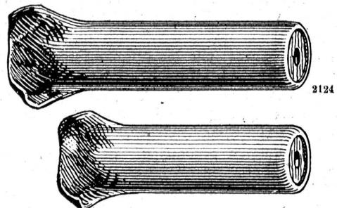
mit eingepresster, quer geschnittener Hart holzfüllung und vorn eingebogener Eisen hülse, in Längen von 30—80 mm und Dicken 9, 11, 14 mm, ist der solideste und zweck mässigste Dübel für alle Zwecke.
