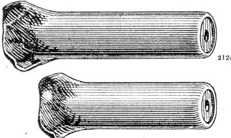
mit eingepresster, quer geschnittener Hartholzfüllung und vorn eingebogener Eisenhülse, in Längen von 30–80 mm und Dicken 9, 11, 14 mm, ist der solideste und zweckmäßigste Dübel für alle Zwecke.
