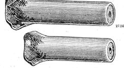
mit eingepresster, quer geschnittener Hart holzfüllung und vorn eingebogener Eisenhülse, in Längen von 30—80 mm und Dicken 9, 11, 14 mm, ist der solideste und zweckmässigste Dübel für alle 3wecke.
