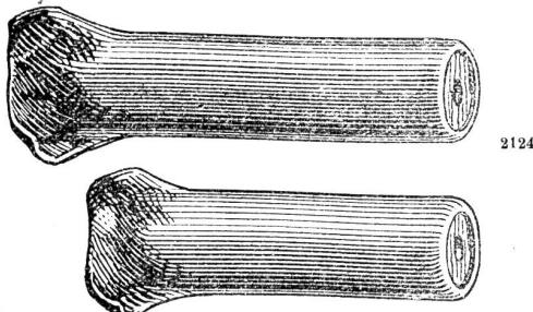
mit eingepresster, quer geschaffener Hartholzfüllung und vorn eingebogener Eisenhülse, in Längen von 30—80 mm und Dicken 9, 11, 14 mm, ist der solideste und zweckmässigste Dübel für alle Zwecke.
