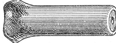
mit eingepresster, quer geschnittener Hartholzfüllung und vorn eingebogener Eisenhülse, in Längen von 30–80 mm und Dicken 9, 11, 14 mm, ist der solideste und zweckmässigste Dübel für alle Zwecke.
