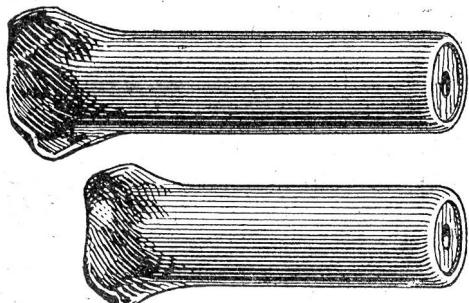
mit eingepresster, quer geschnittener Hartholzfüllung und vorn eingebogener Eisenhülse, in Längen von 30—80 mm und Dicken 9, 11, 14 mm, ist der solideste und zweckmässigste Dübel für alle Zwecke.
