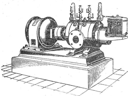
Direkte Kupplung mit Elektromotoren o. Riemenbetrieb.
