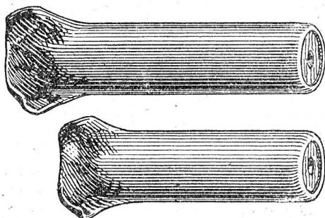
mit eingepresster, quer geschnittener Hartholzfüllung und vorn eingebogener Eisenhülse, in Längen von 30—80 mm und Dicken 9, 11, 14 mm, ist der solideste und zweckmässigste Dübel für alle Zwecke.
