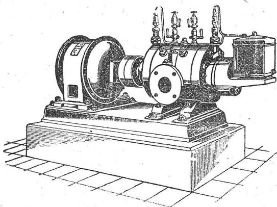
Direkte Kupplung mit Elektromotoren o. Riemenbetrieb.
