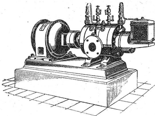
Direkte Kupplung mit Elektromotoren o. Riemenbetrieb.
