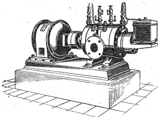
Direkte Kupplung mit Elektromotoren o. Riemenbetrieb.
