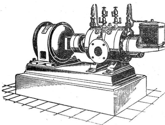
Direkte Kupplung mit Elektromotoren o. Riemenbetrieb.
