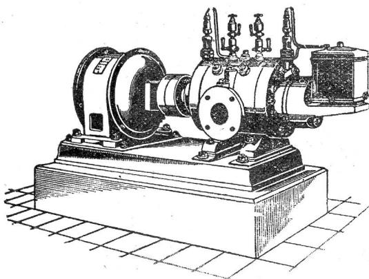
Direkte Kupplung mit Elektromotoren o. Riemenbetrieb.
