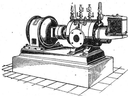
Direkte Kupplung mit Elektromotoren o. Riemenbetrieb.
