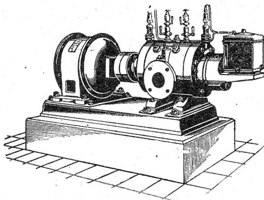
Direkte Kupplung mit Elektromotoren o. Riemenbetrieb.
