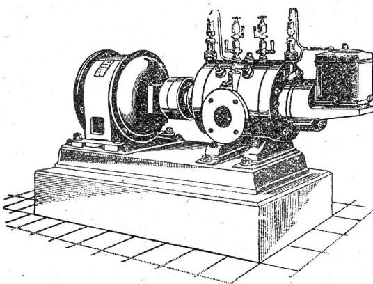
Direkte Kupplung mit Elektromotoren o. Riemenbetrieb.
