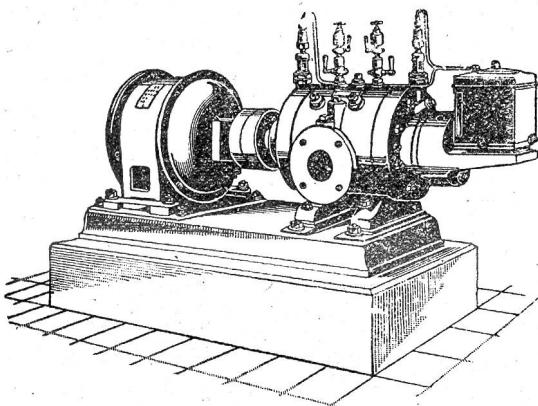
Direkte Kupplung mit Elektromotoren o. Riemenbetrieb.
