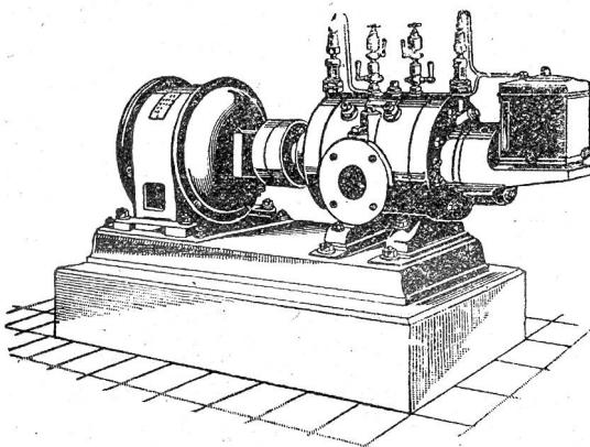
Direkte Kupplung mit Elektromotoren o. Riemenbetrieb.
