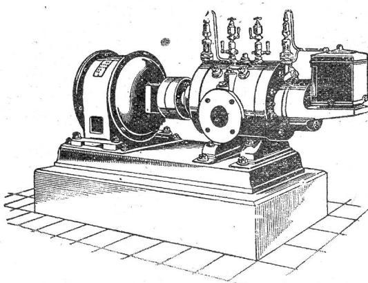
Direkte Kupplung mit Elektromotoren o. Riemenbetrieb.
