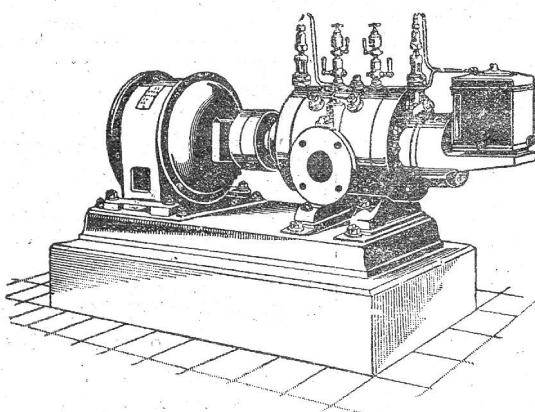
Direkte Kupplung mit Elektromotoren o. Riemenbetrieb.
