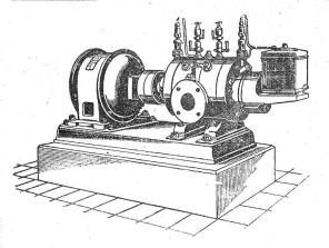
Direkte Kupplung mit Elektromotoren o. Riemenbetrieb. Ruhiger Gang, Luftförderung ohne Stösse.
