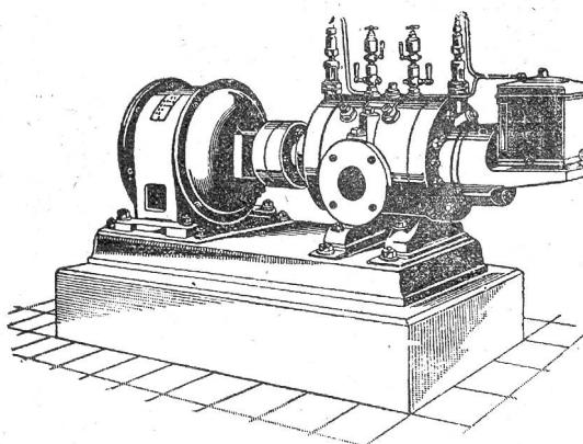
Direkte Kupplung mit Elektromotoren o. Riemenbetrieb.
