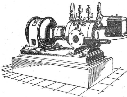
Direkte Kupplung mit Elektromotoren o. Riemenbetrieb.
