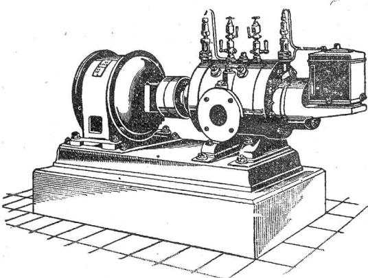
Direkte Kupplung mit Elektromotoren o. Riemenbetrieb.
