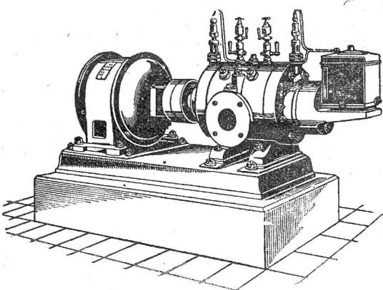
Direkte Kupplung mit Elektromotoren o. Riemenbetrieb.
