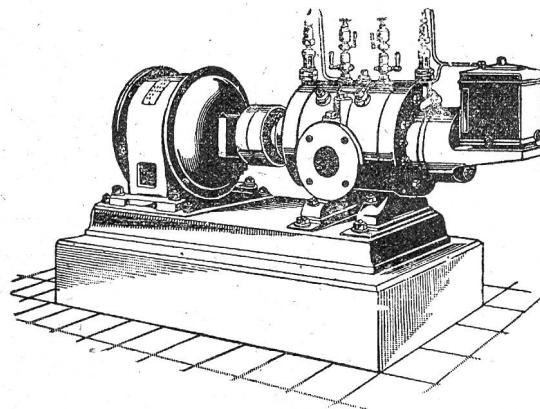
Direkte Kupplung mit Elektromotoren o. Riemenbetrieb.
