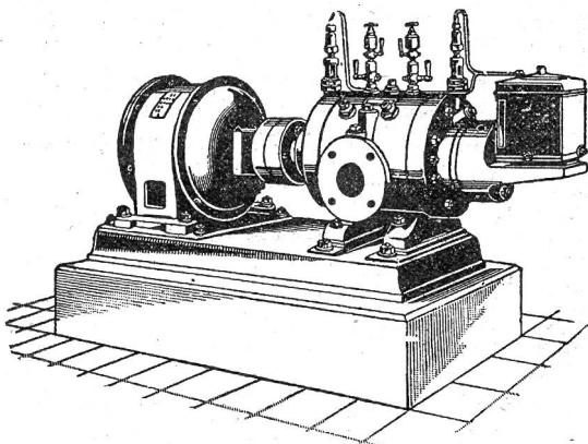
Direkte Kupplung mit Elektromotoren o. Riemenbetrieb.
