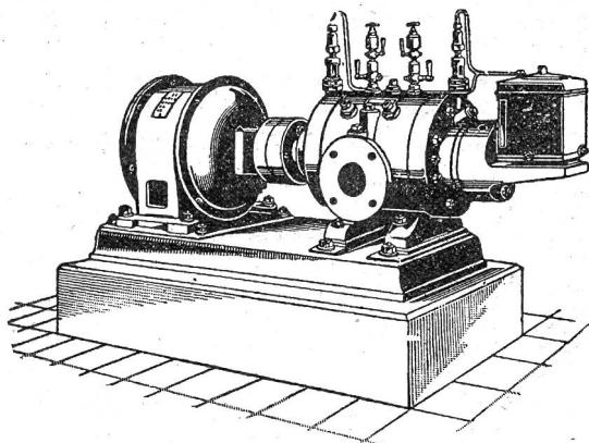
Direkte Kupplung mit Elektromotoren o. Riemenbetrieb.
