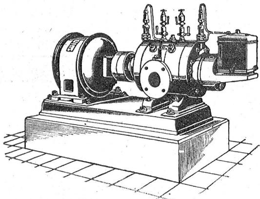
Direkte Kupplung mit Elektromotoren o. Riemenbetrieb.
