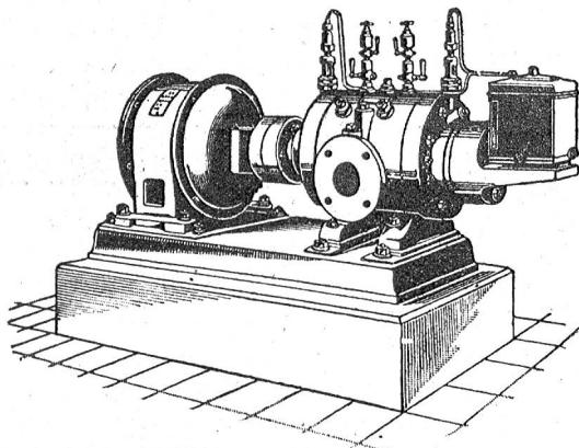
Direkte Kupplung mit Elektromotoren o. Riemenbetrieb.
