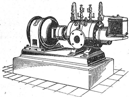
Direkte Kupplung mit Elektromotoren o. Riemenbetrieb.
