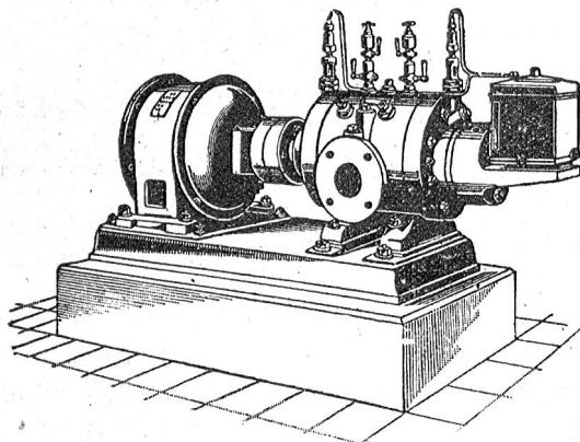
Direkte Kupplung mit Elektromotoren o. Riemenbetrieb.
