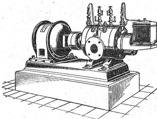
Direkte Kupplung mit Elektromotoren o. Riemenbetrieb.
