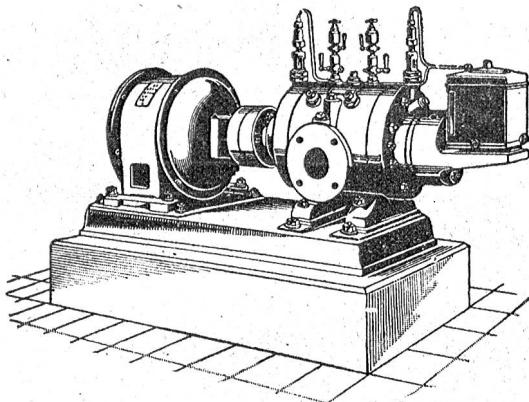
Direkte Kupplung mit Elektromotoren o. Riemenbetrieb.
