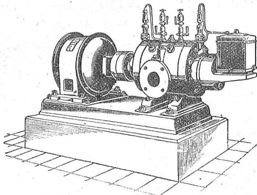
Direkte Kupplung mit Elektromotoren o. Riemenbetrieb.
