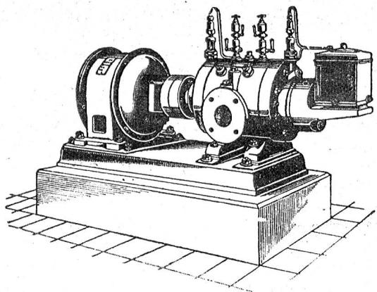
Direkte Kupplung mit Elektromotoren o. Riemenbetrieb.
