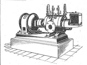
Direkte Kupplung mit Elektromotoren o. Riemenbetrieb. Ruhiger Gang, Lustförderung ohne Stösse.
