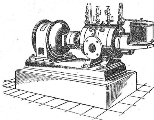
Direkte Kupplung mit Elektromotoren o. Riemenbetrieb.
