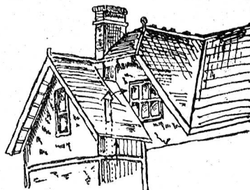
Figur 6. Fehlerhafte Anordnung der Ausmündung vom Ventilationsrohr in der Nähe von Fenstern.
