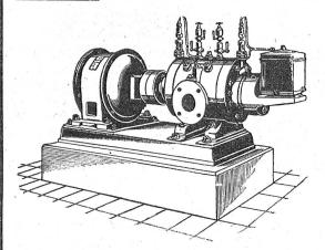
Direkte Kupplung mit Elektromotoren o. Riemenbetrieb. Ruhiger Gang, Luftförderung ohne Stösse.
