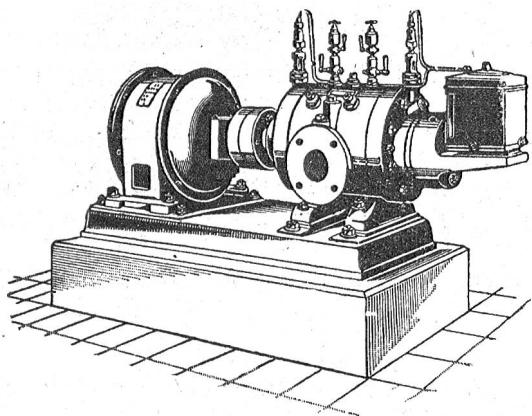
Direkte Kupplung mit Elektromotoren o. Riemenbetrieb.
