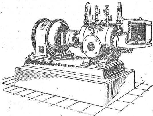
Direkte Kupplung mit Elektromotoren o. Riemenbetrieb.
