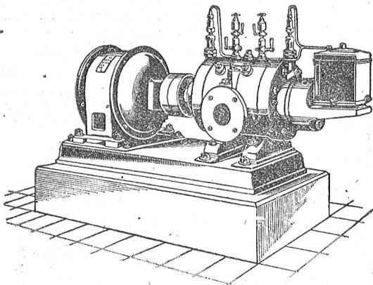
Direkte Kupplung mit Elektromotoren o. Riemenbetrieb.
