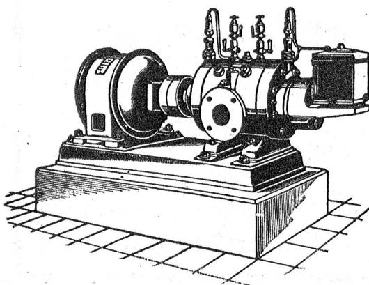
Direkte Kupplung mit Elektromotoren o. Riemenbetrieb.
