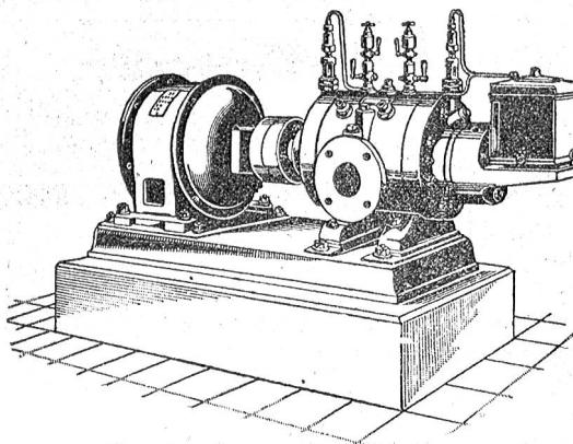
Direkte Kupplung mit Elektromotoren o. Riemenbetrieb.
