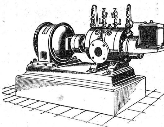
Direkte Kupplung mit Elektromotoren o. Riemenbetrieb.
