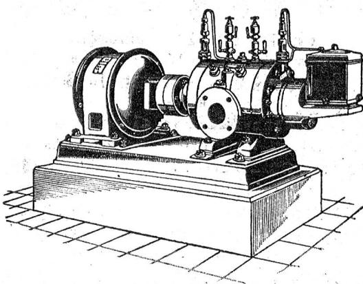
Direkte Kupplung mit Elektromotoren o. Riemenbetrieb.
