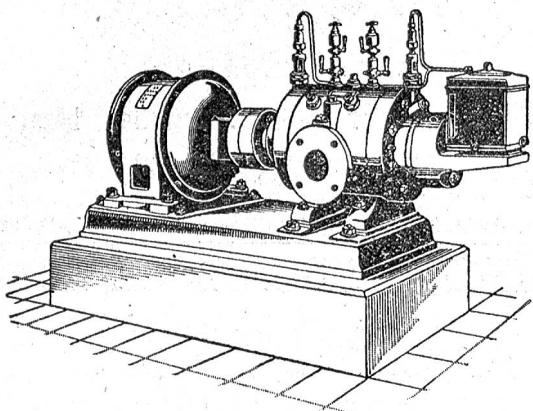
Direkte Kupplung mit Elektromotoren o. Riemenbetrieb.
