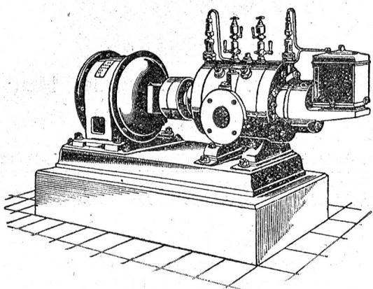
Direkte Kupplung mit Elektromotoren o. Riemenbetrieb.
