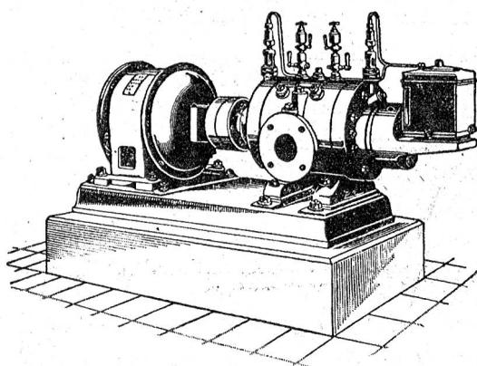
Direkte Kupplung mit Elektromotoren o. Riemenbetrieb.
