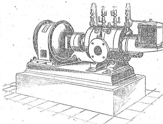
Direkte Kupplung mit Elektromotoren o. Riemenbetrieb.
