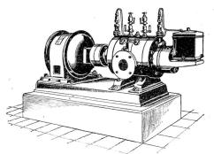
Direkte Kupplung mit Elektromotoren o. Riemenbetrieb. Ruhiger Gang, Luftförderung ohne Stösse.
