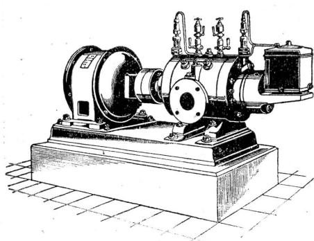
Direkte Kupplung mit Elektromotoren o. Riemenbetrieb.
