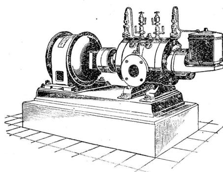
Direkte Kupplung mit Elektromotoren o. Riemenbetrieb.
