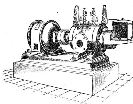
Direkte Kupplung mit Elektromotoren o. Riemenbetrieb.
