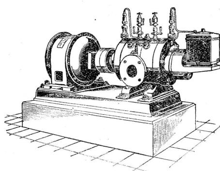
Direkte Kupplung mit Elektromotoren o. Riemenbetrieb.
